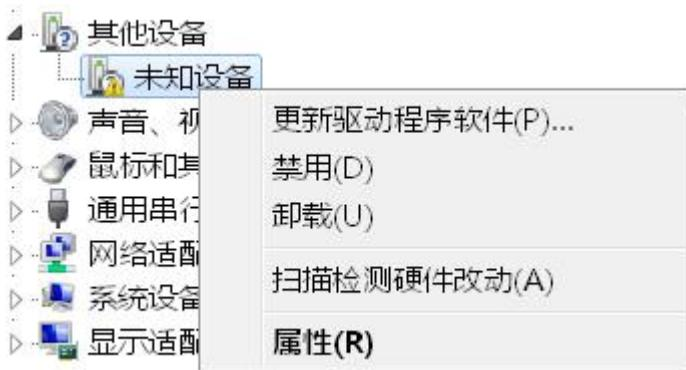
在“更新驱动程序软件”界面下 选择“浏览计算机以查找驱动程序软件”继续完成下一步
