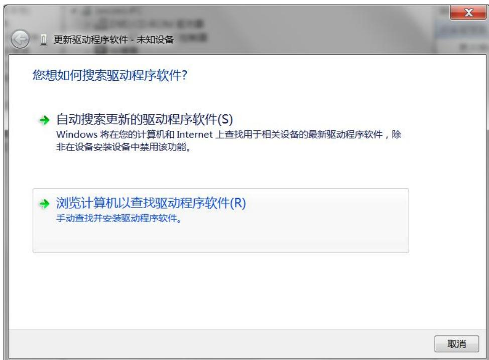
点击“浏览”，选择光盘中驱动程序 USBDrv.sys 所在的路径，单击“下一步”继续安装
